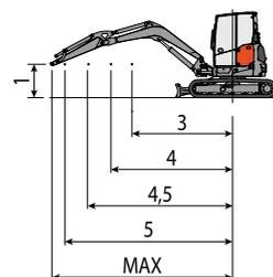
La capacidad de elevación se basa en la norma ISO 10567 y no excede el 75% de la carga estática de vuelco o el 87% de la capacidad de elevación hidráulica de la máquina.
