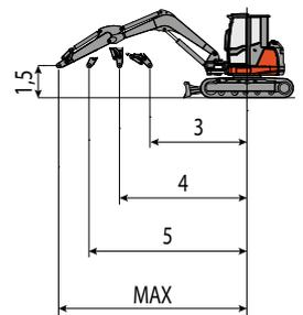
La capacidad de elevación se basa en la norma ISO 10567 y no excede el 75% de la carga estática de vuelco o el 87% de la capacidad de elevación hidráulica de la máquina.
