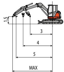
La capacidad de elevación se basa en la norma ISO 10567 y no excede el 75% de la carga estática de vuelco o el 87% de la capacidad de elevación hidráulica de la máquina.
