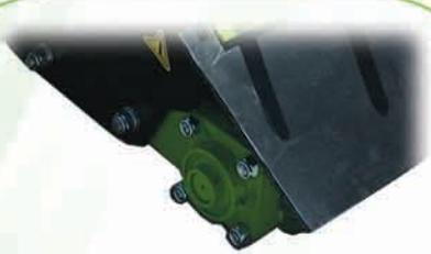
Rodillo posicionador regulable en altura con doble rodamiento.
